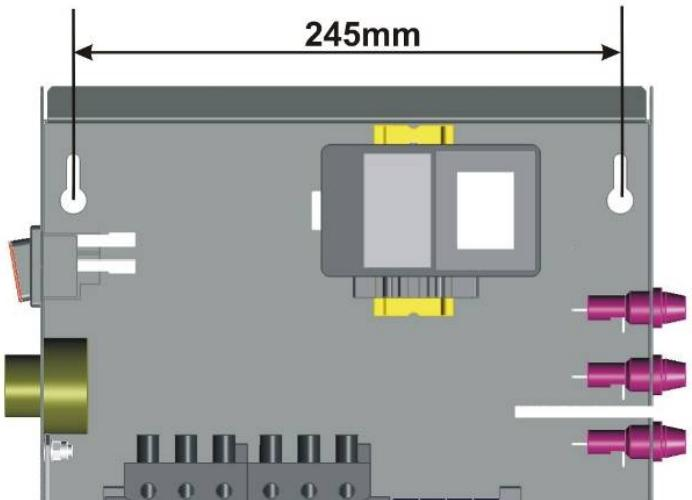
Панель крепится на стену при помощи двух прилагаемых дюбельных болтов. В целях обеспечения вентиляции необходимо, чтобы вокруг всей панели было как минимум 10 см свободного пространства.
